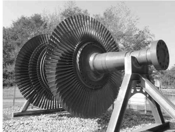
**32** Niederdruckdampfturbinenläufer aus Block D des
