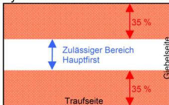
Der Hauptfirst bei Bautyp E muss eine Mindestlänge von 60 % der Gebäudelänge (traufseitige Außenwand) aufweisen. Diese ist in das Verhältnis zu setzen von der äußeren Wandoberfläche der giebelseitigen Außenwände zu den äußeren Punkten des Firstes an der Oberseite Dachhaut. Die Lage des Firstes ist gebäudemässig zu situieren (vgl. nachfolgende Systemskizze Dachaufsicht Walmdach).
