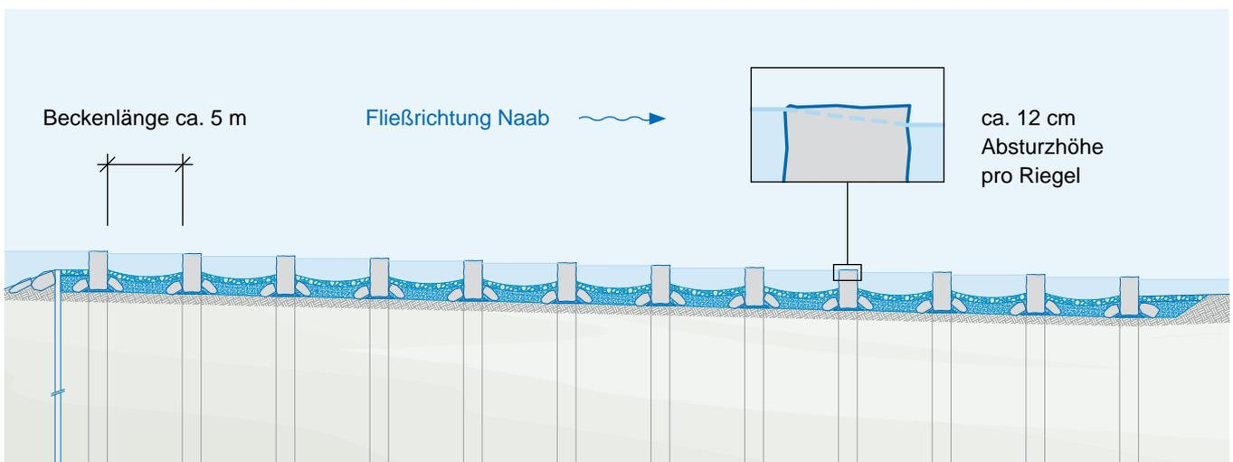
Längsschnitt durch die Rampe, schematische Darstellung
