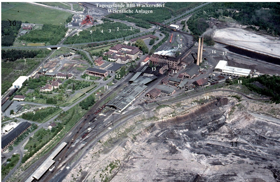
Von Westen gesehen: 1 Garagen, 2 Gemeinschaftshaus, 3 Verwaltung, 4 Schwesternheim, Badeanstalt, Sanitätsstation, 5 Bundesstraße B85, 6 Sägewerk, Schreinerei, Zimmerei, 7 Lok-Halle, 8 Bauhof, 9 Lokwerkstatt, 10 Vulkanisierwerkstatt, 11 Brikettverladung, 12 Lehrwerkstatt, 13 Brikettfabrik, 14 Zentralwerkstatt, 15 Kesselhaus, 16 Schornsteine, 17 Magazin, 18 Tagebau Westfeld 19 Malerei, 20 Steiger-/Meisterbüro (Karl Jobst)
