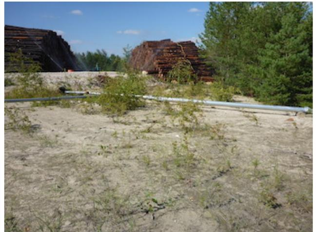
Abb. 4: Lagerflächen und Holz-Sprinkler
