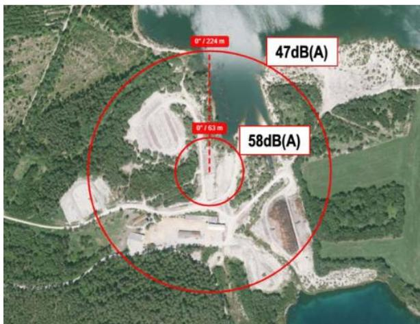
Abb. 14: Betrieb einer Maschine mit 102dB(A) auf dem Lärmmessplatz
