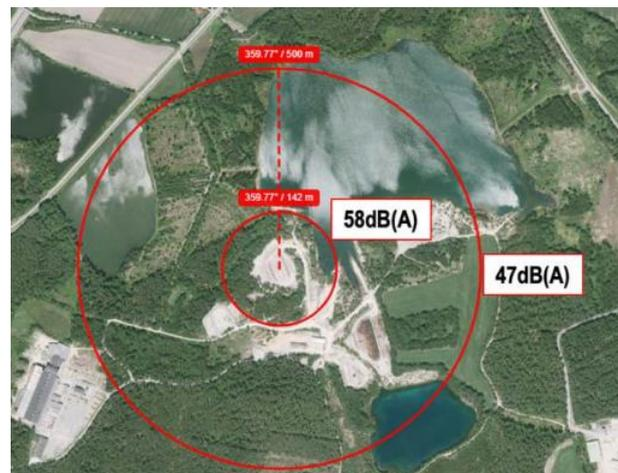
Abb. 15: Vier Bagger gleichzeitig in Betrieb auf dem Baggerplatz = 109dB(A)
