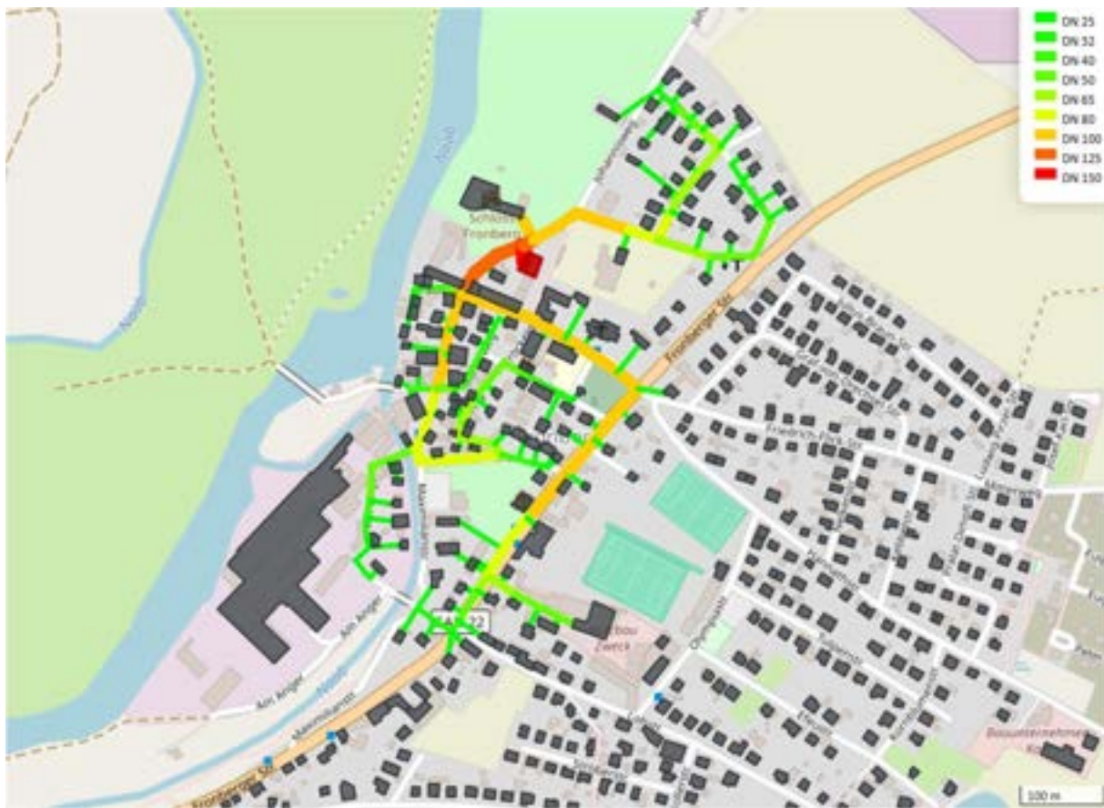
Abbildung 102: Mögliches Wärmenetz Fronberg V1
