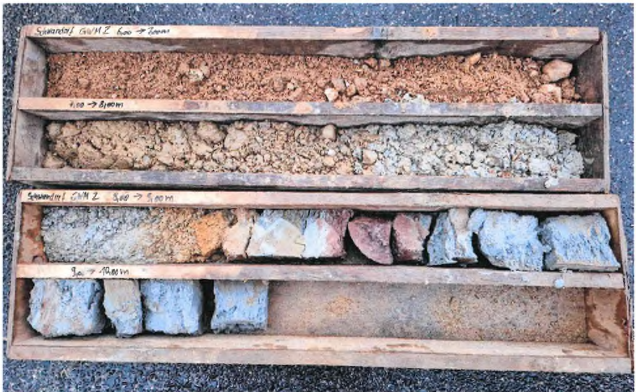
Fotos 03-04: Bohrkern der GWM2, 0,00 - 9,30 m u. GOK
