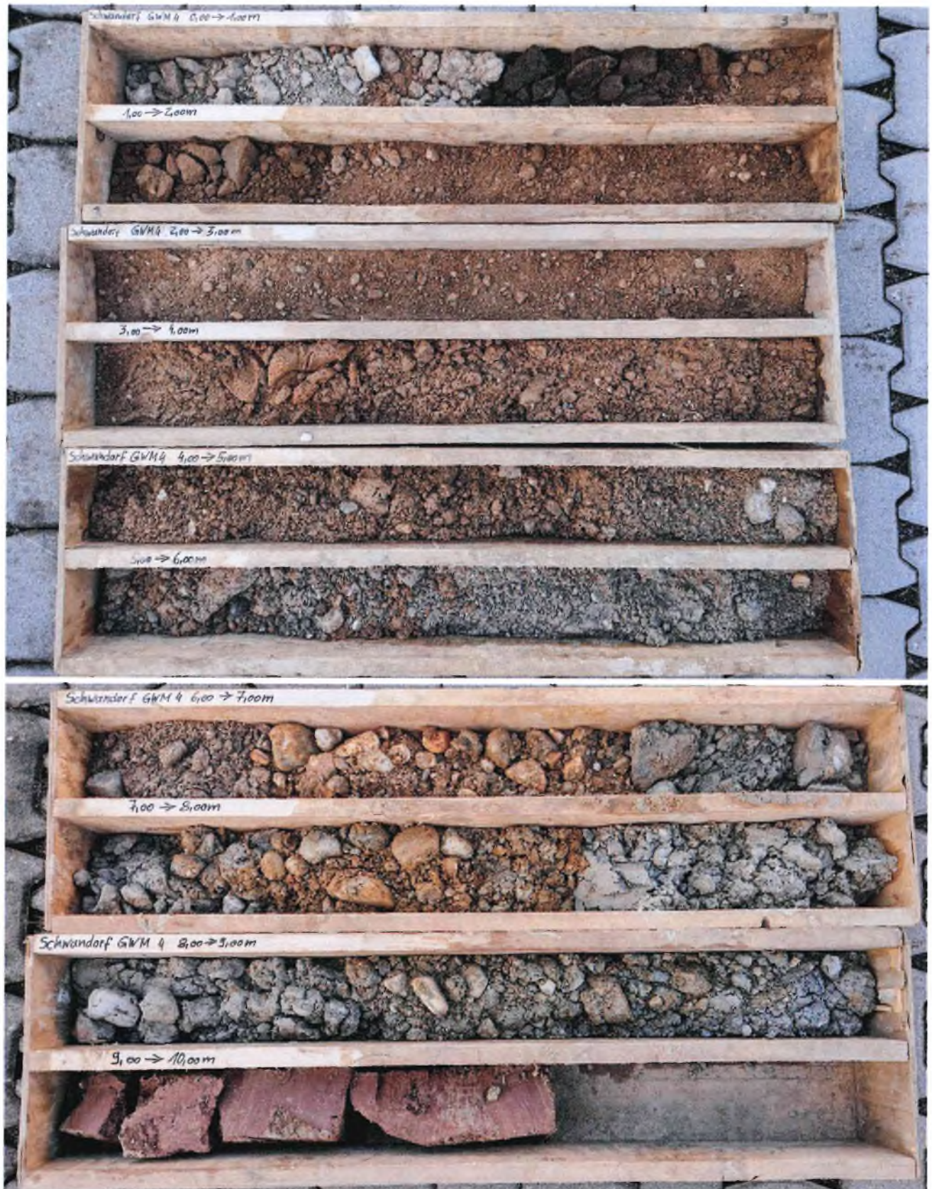
Fotos 07-08: Bohrkern der GWM4, 0,00 - 9,60 m u. GOK
