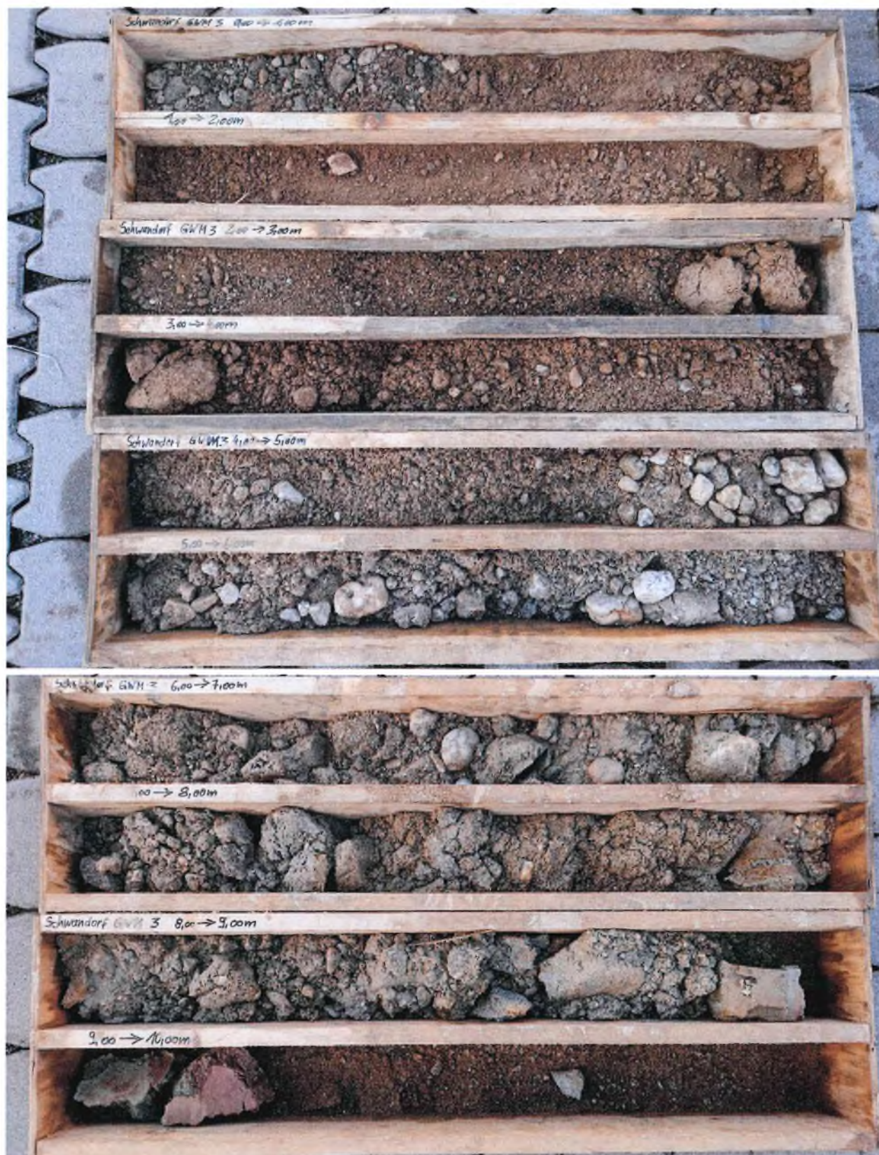
Fotos 05-06: Bohrkern der GWM3, 0,00 - 9,30 m u. GOK
