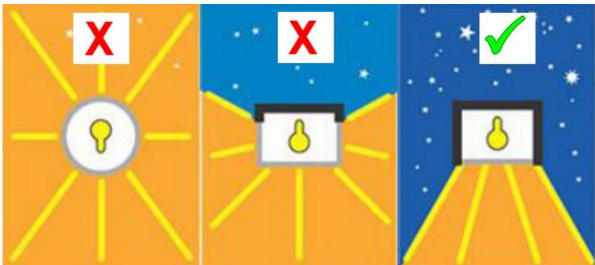
Abbildung 6: Schematische Darstellung der Ausleuchtung in Abhängigkeit von der verwendeten Abschirmung des Leuchtmittels. Links: Ohne Abschirmung, Mitte: Unzureichende Abschirmung. Rechts: Ideale Abschirmung mit nur nach unten gerichtetem Lichtkegel.
